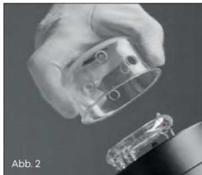
**Abb. 1 + 2:** Ziehen Sie die Schutzglocke vorsichtig nach oben ab, um die Blitzröhre freizulegen. Nutzen Sie dabei bitte stets saubere Baumwollhandschuhe oder ein Mikrofasertuch.
