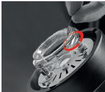
Abb. 1: Wickeln Sie den verdrehten Zünddraht von der Blitzröhrenhalterung ab und ziehen Sie die Blitzröhre vorsichtig aus dem Gerät.
