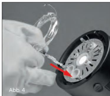
**Abb. 3:** Wickeln Sie den verdrehten Zünddraht von der Blitzröhrenhalterung ab und ziehen Sie die Blitzröhre vorsichtig aus dem Gerät.
